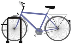
Gabelhalter verhindern eine Beschädigung des Vorderrades, indem die Gabel und je nach Rahmengenometrie auch ein Teil des Rahmens angelehnt werden können. Teilweise sind noch zusätzliche Elemente angebracht, die ein Wegrutschen des Vorderrades verhindern („Focussystem“ beim Modell Beta).
