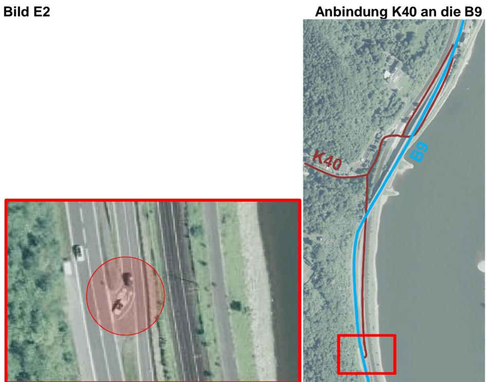
Aufgrund der spitzwinkligen Zufahrt, der damit verbundenen schlechten Sichtverhältnisse und der hohen Belastungen im Zuge der B9, ist der plangleiche Linkseinbieger in Fahrtrichtung Koblenz sicherheitstechnisch als kritisch einzuschätzen.
