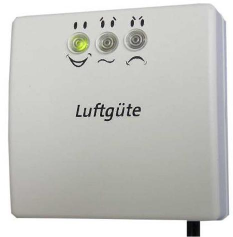
Steigt die Kohlendioxidkonzentration der Raumluft auf über 1.500 ppm, leuchtet die gelbe LED auf, ein kurzes Piepen ertönt. Die Luftgüte ist mittelmäßig. Ein Lüften wird empfohlen.
