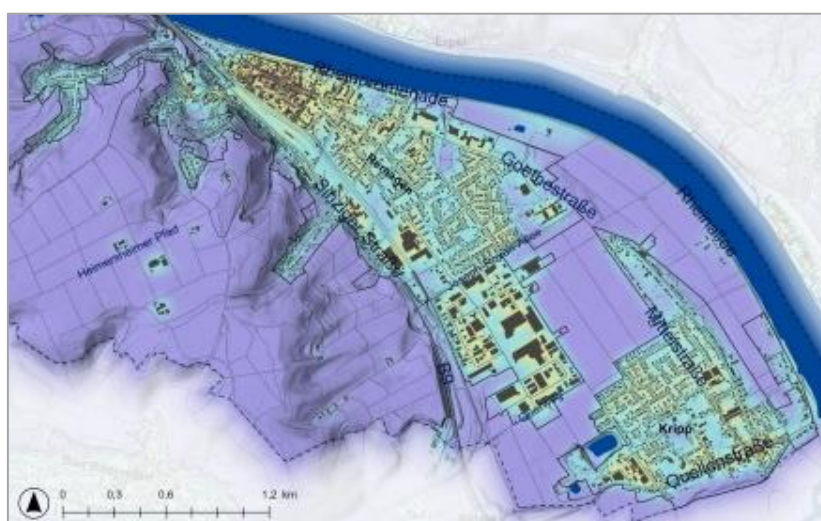
Abbildung 19: Kartenauszug der Themenkarte „Bodennahe nächtliche Lufttemperatur“ für die Kernstadt Remagen sowie den Ortsbezirk Kripp. Für den Bereich wird die Lufttemperatur auf 2 m für 4:00 Uhr nachts an einem heißen Tag simuliert, wodurch der städtische Wärmeinseleffekt abgebildet wird (BPI 2024).
