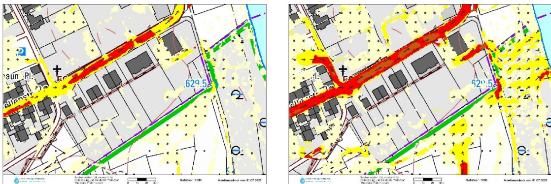
Abbildung 2: Fließgeschwindigkeiten bei SRI 7 (links) und SRI 10_4h (rechts)
